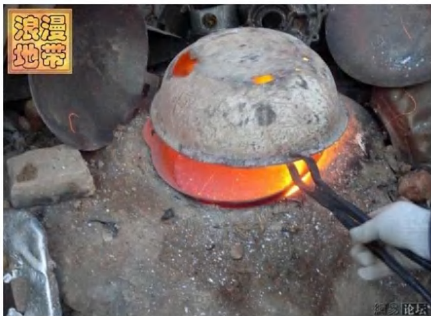
Небольшая печь для выплавки алюминия. Работает на угле (древесных углях), которые предварительно внутри разжигаются .
