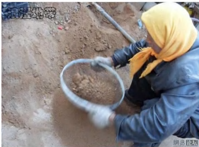
Просеивание формовочной смеси (похоже, почва в этой местности Китая вполне годится как формовочная смесь).
